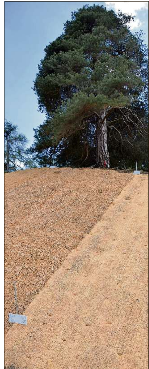
Die Versuchsfläche in Rhäzüns weist rund 500 Quadratmeter auf und wurde mit verschiedenen Holzwollearten und Samen versehen. Bilder sj
