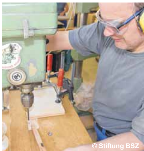
Karl Schuler (links) und Damian Schatt (Mitte) stellen die Holznägel (rechts) für die Fixierung der Holzwollevliese im Boden her.
