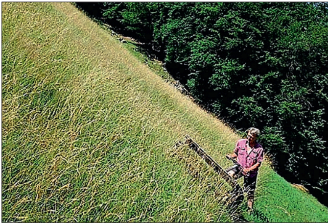
Abb. 1: Der eBeetle bei der Saatguternte im Steilhang im Einsatz. Fig. 1: L'eBeetle en pleine récolte sur une pente raide.
