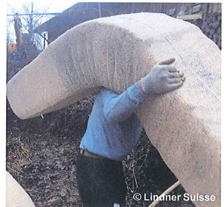
Astfreies Holz wird auf der Holzwollemaschine vorsichtig zu bis zu 50 cm langen, elastischen Holzwollefäden verarbeitet. Das geringe Gewicht und die Verformbarkeit der Q-Faschinen erleichtert den Transport und macht den Einsatz flexibel.
