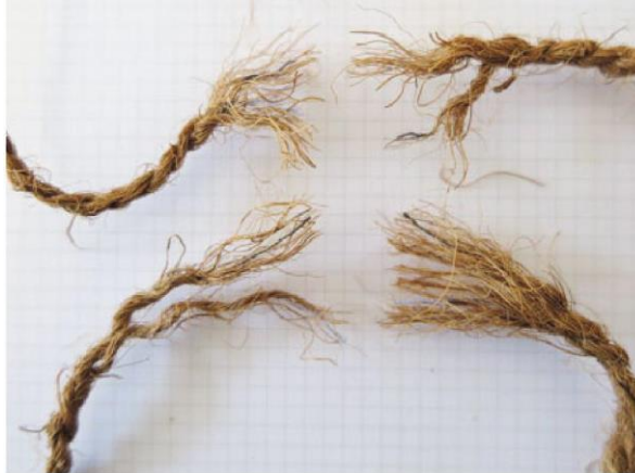
Fibres synthétiques dans une toile en coco (Photo: Université des sciences appliquées des Grisons)
