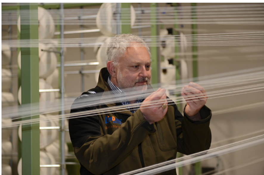
Geschäftsführer Thomas Wildberger kontrolliert die Fäden der neu installierten Textilmaschine, welche die nachhaltigen Netze aus Buchenholz-Zellulose produziert.
