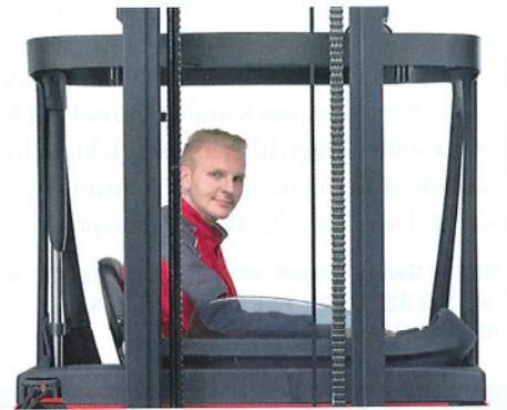
Profilen welches auf Hubhöhen bis zu 7700 Millimeter reicht. Der Fahrersitz ist mechanisch gedämpft und hemmt Stösse bei Bodenunebenheiten. Die Batteriegrössen der 48-Volt-Geräte reichen von 360 bis 620 Amperestunden (Ah).
