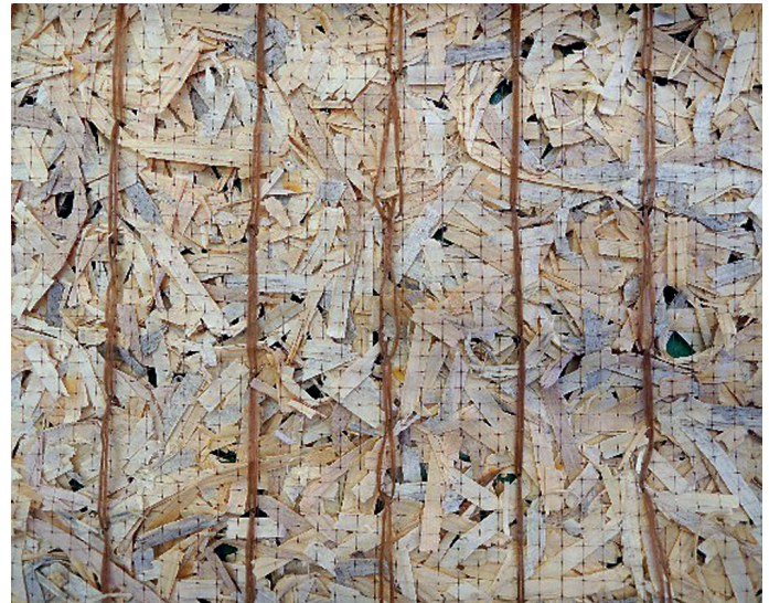
Abb. 1: Holzwollematte aus groben Fasern
