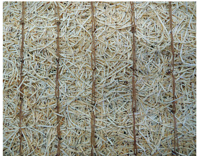
Abb. 2: Holzwollematte aus feinen Fasern
