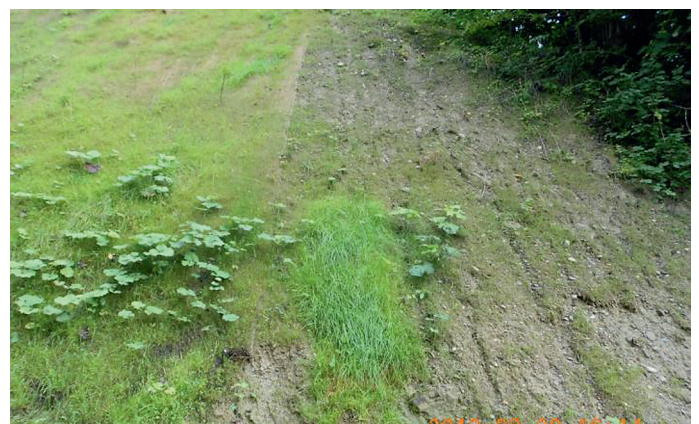
Abb. 11: Versuchsfläche (links) und Kontrollfläche (rechts), Die Vegetation auf der Versuchsfläche ist deutlich besser entwickelt [6] Fig. 11: Testing area (left) and control area (right), vegetation on testing area is clearly better developed
