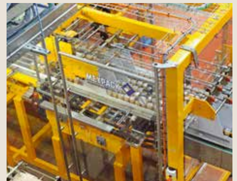
Die Anlage verarbeitet Dosen, Glas- und PET-Gebinde.
