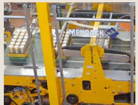
Übersichtlich, leicht zugänglich, 60 Takte/min: Meypack-Anlage.
