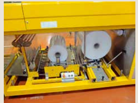
Der Schrumpfbereich, das zweite Modul der Anlage, das bei Bedarf auch ausgeschaltet werden kann.
